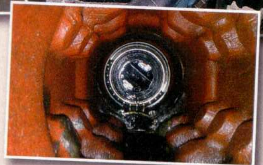
Lager mit Kugelschwund im Achstrichter.
